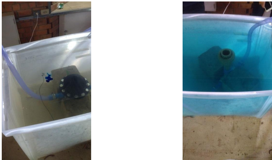
Figura 30 – Ensaio de contaminação do eliminador Dolphin e da válvula ventosa Tigre, respectivamente.
