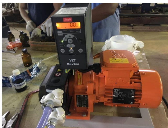
Figura 24 – Detalhe da bomba peristáltica utilizada no ensaio em laboratório.
