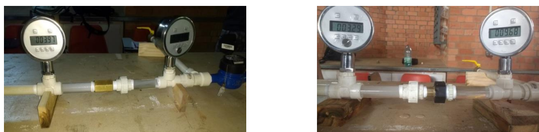
Figura 22 – Bancada em teste com os manômetros e o bloqueador de ar Air Bloch (em latão).
