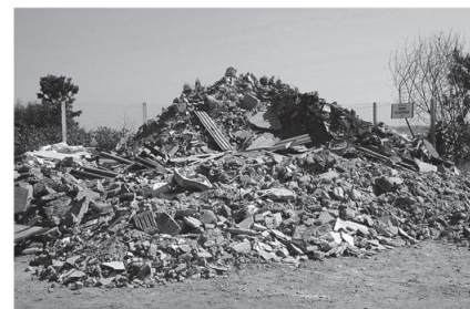
FIGURA 15 - Entulho de resíduo de construção civil armazenado no Ecoporto do Cecap
